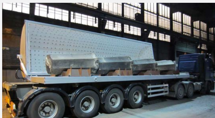
Ein speziell mit dem von RKI patentierten Sicherheitssystem ausgerüsteter Hauben-LKW, damit das Gut nicht nur heiß, sondern auch sicher ans Ziel kommt.
