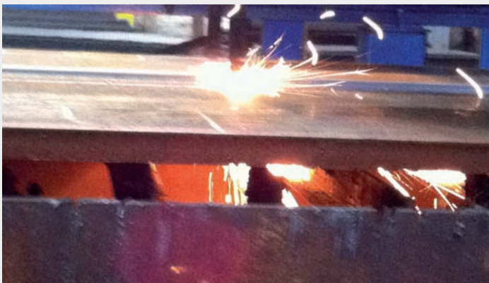
Am Brenntisch werden die Bleche – auch kurzfristig – auf das gewünschte Maß gebracht.
